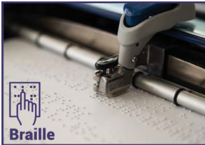
Figura 9. Estampadora de braille que imprime páginas de braille
